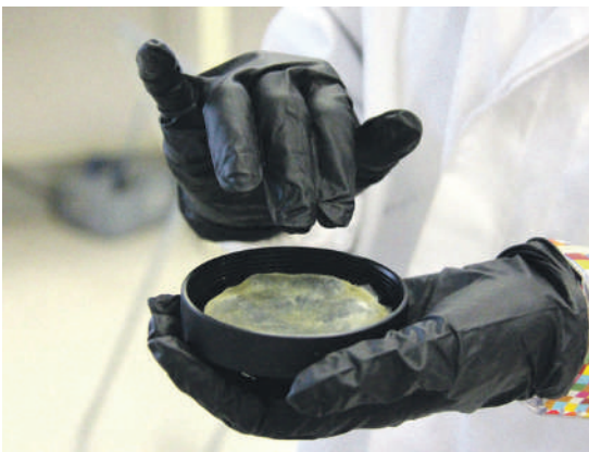
Film baten ur lurrunaren iragazkortasuna aztertzeke ontziaren muntaia.
